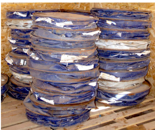
Figura 14: Pila de bidones de 200 litros aplastados
